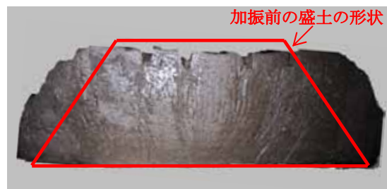
図-5 加振後の崩壊状況
