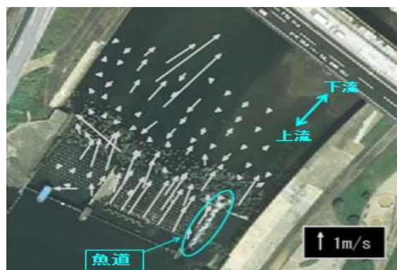
図-3 堰直下の流速ベクトル(干潮時)
