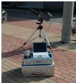
図1 レーザドップラ速度計
