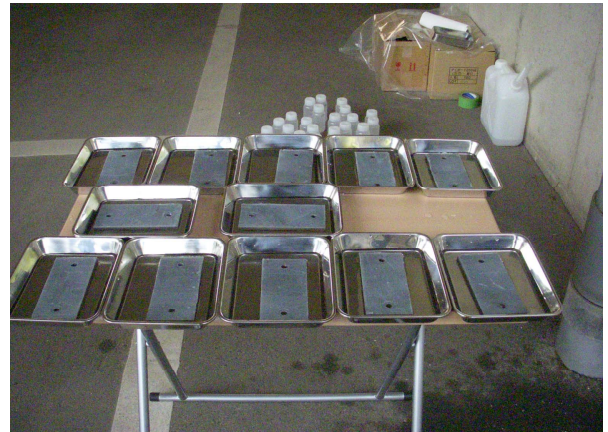
図-1 水浸漬による洗浄の状況
