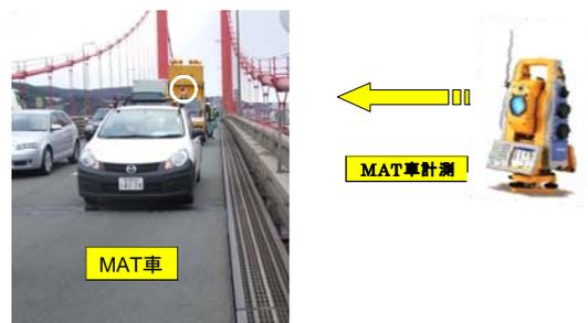
図-3 MAT車による路面縦断計測方法
