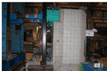
写真-2 背面土有りのケース(左：最大荷重時、右：載荷終了後のパラペット部)
