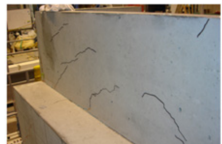
写真-1 背面土無しのケース(左：最大荷重時、右：載荷終了後のパラペット部) 1)
