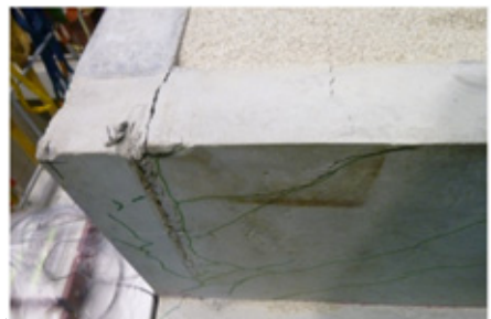
写真-2 背面土有りのケース(左：最大荷重時、右：載荷終了後のパラペット部)
