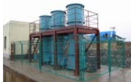
写真1 大型ライシメータ（上海市老港埋立地）
