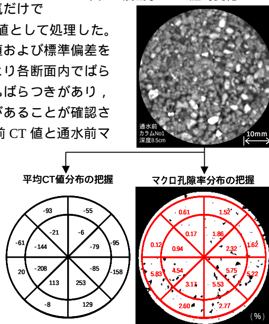
図 4 X 線 CT 画像解析方法
