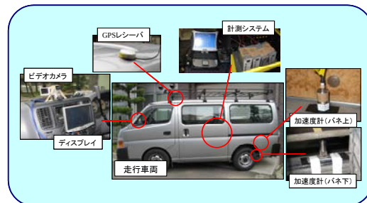
図-1 車両搭載型路面計測システム
