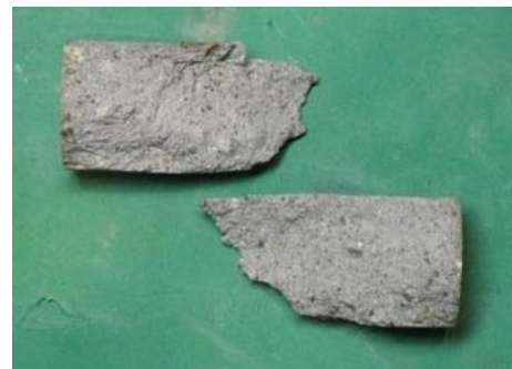
写真-1 小径コアの圧縮強度試験後の破壊状況の例
