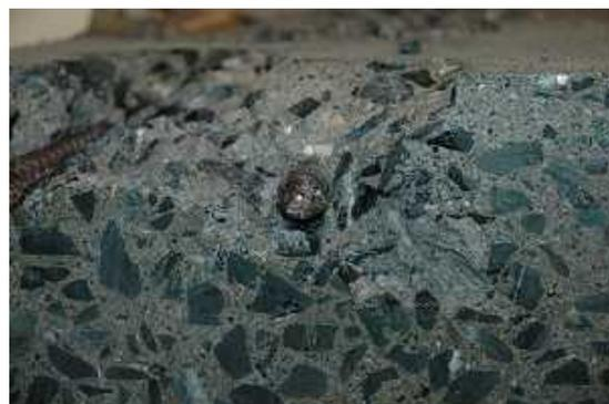
図-4 放電漏れによる側面破碎
