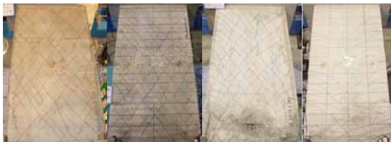
写真-1 最大耐力時のひび割れ状況 (左から No.1, 2, 3, 4)
