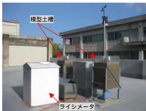
写真 - 1 土槽実験装置
