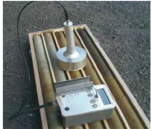
図-2 ボーリングコア線測定装置
