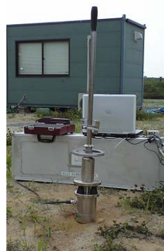
写真-1 小型 FWD 装置による野外試験風景
