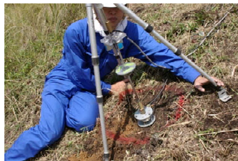
写真-2 改良型 FWD 装置による試験風景
