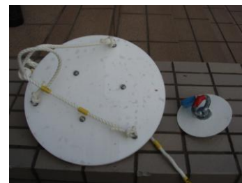
写-1 透明度板 (左: 市販の白色セッキ板、右: 自作 CD 板)
