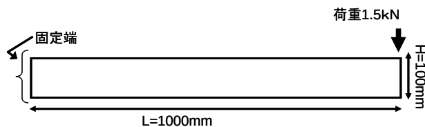
図-1 片持ちばり弾性解析モデル
