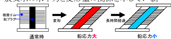
図-4 免震支承の鉛の応力緩和
