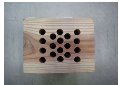
写真-6 人工的に劣化させた木材
