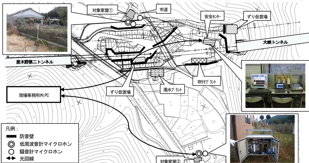
図 1 トンネル坑口・仮設備・防音設備・監視対象家屋の配置
