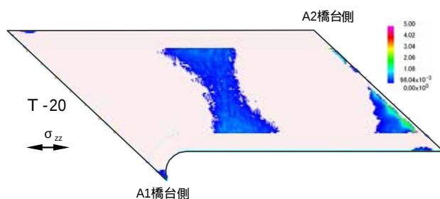
図-4 橋軸方向の引張応力分布状況
