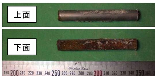
写真-2 鉄筋腐食状況(供試体B鉄筋No.1)
