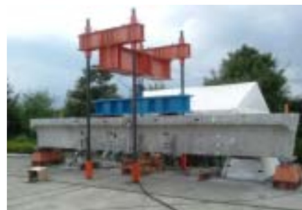
図-4 試験体設置状況
