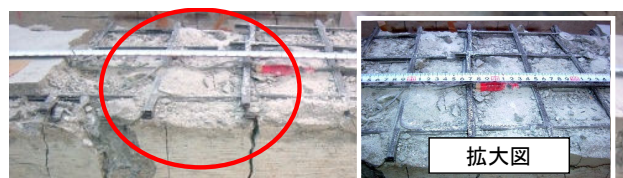
(a) FRP グリッド付着破壊 (Type2)
