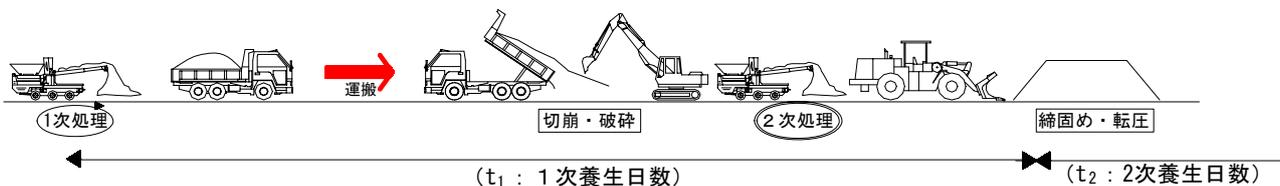
図-1 2 段階処理施工パターン<sup>2)</sup>
