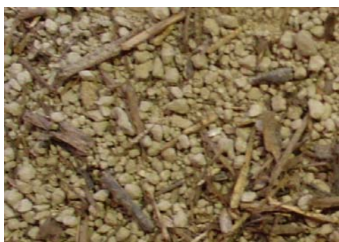
写真1 まさ土（加水前）+木質系廃棄物 3%（左：チップ、右：バーク）
