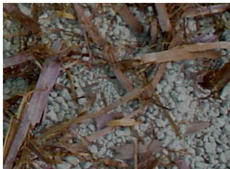
写真1 まさ土（加水前）+木質系廃棄物 3%（左：チップ、右：バーク）
