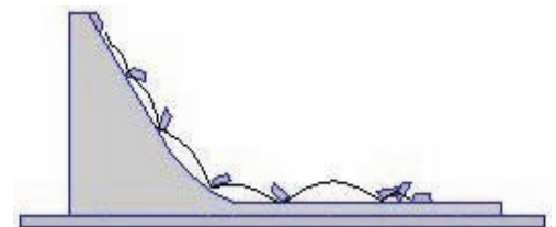
図-5 地震時(周期 2.0sec)の崩壊土石の動き
