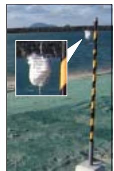
図 - 3 塩分捕捉器の設置状況
