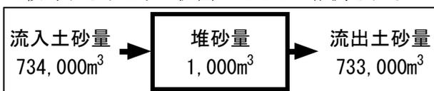
図-4 小丸川中・下流河道区間における土砂収支の計算
