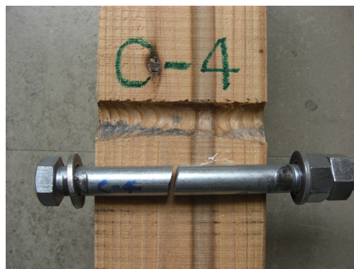
写真-2 破断したボルトとめり込みが生じた木材
