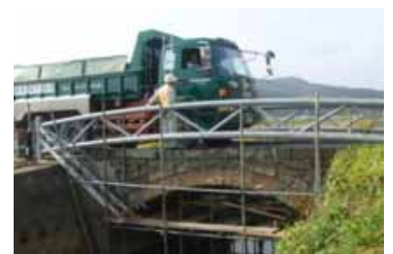
写真2 軸荷重の静的載荷状況
