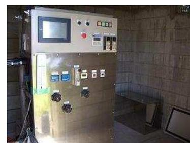
図 1 メディマート 220 図 2 極性転換方式電気透析装置
