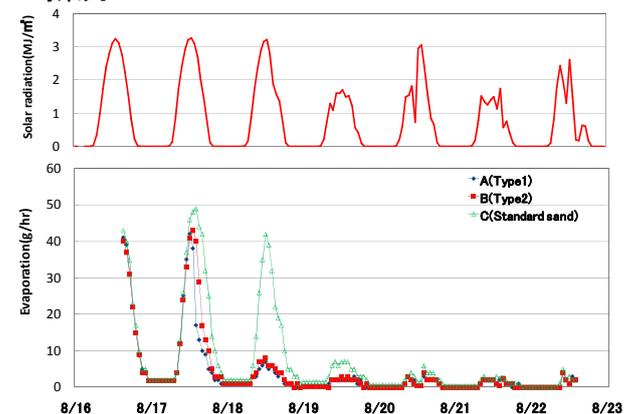
図-5 模型実験による人工芝システムからの蒸発量と日射量の時系列
