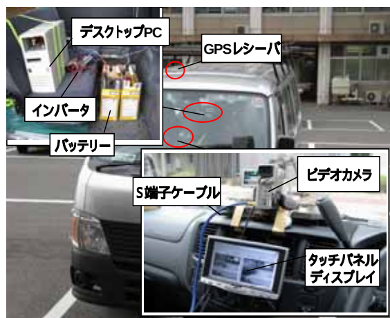
図 - 3 システム搭載状況
