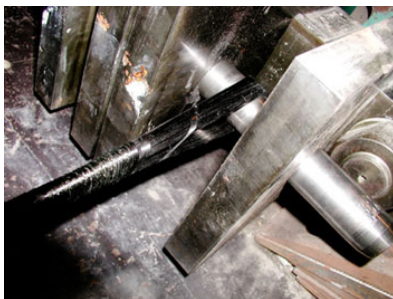
図—3 アンカーの治具設置状況
