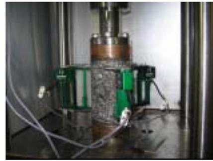
図-3: 一軸圧縮疲労試験機
