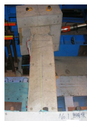
写真-1 無補強 (C-C 断面の破壊)
