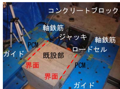
写真-1 九大式付着強度試験
