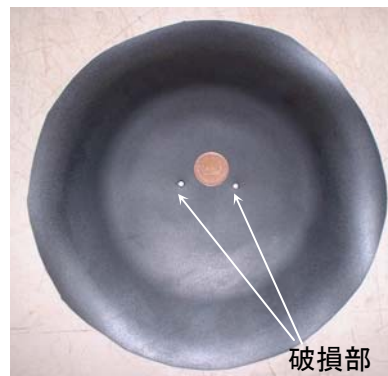
図-3 塩化ビニル遮水シート 円形複数破損
