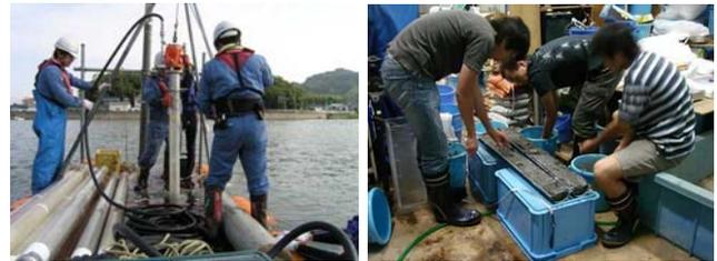
図-1 パイプレーションコアサンプラーと作業風景
