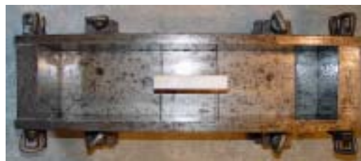
写真-1 供試体型枠
