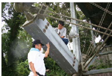
写真-4 超音波伝播速度試験の様子
