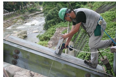
写真-5 穿孔抵抗試験の様子
