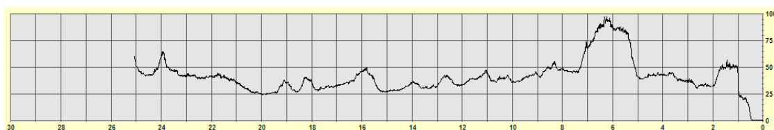
図-2 図-1 ①の地点の穿孔抵抗試験の結果
