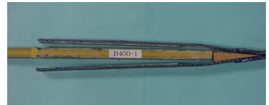
写真-1 破壊状況(付着長 400mm)
