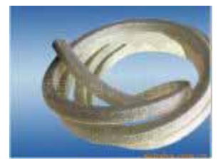
図-4 石綿のパッキング
