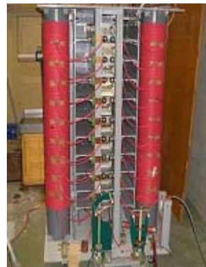
図1 パルスパワー発生装置 図2 電極構造
