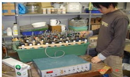
写真-1 供試体を模擬海水に浸した状況
