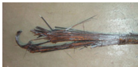
図-9 U 型アンカー破断状況
