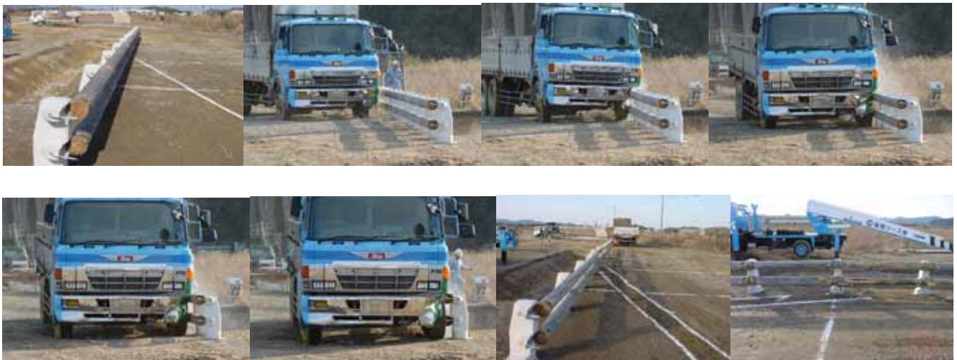
図-3 衝突車両の挙動および横梁の損傷状況
