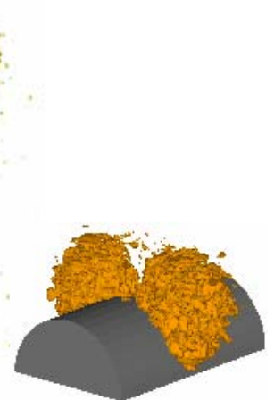
図-8 豊浦砂の ゆるみ・空洞領域抽出画像
