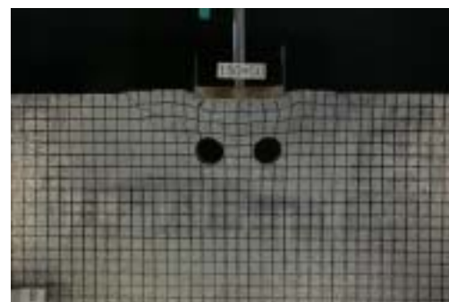
図-3 観察された破壊メカニズム ( H/D=1.5, d/D=2.0, S/L=0.0266 )
